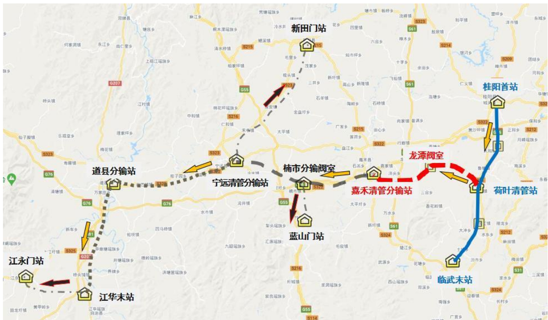
图：桂阳-嘉禾输气管道输配系统及流向示意图
